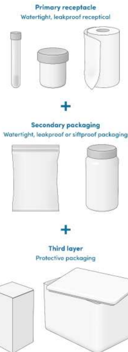
Fig. 6.1 Exemples de système de base de triple emballage
